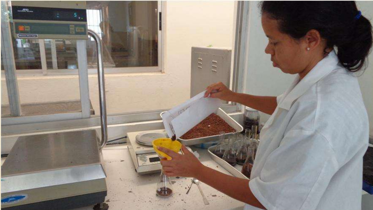
Fig. 4. Pesado de los sustratos y colocación en frasco erlenmeyer
