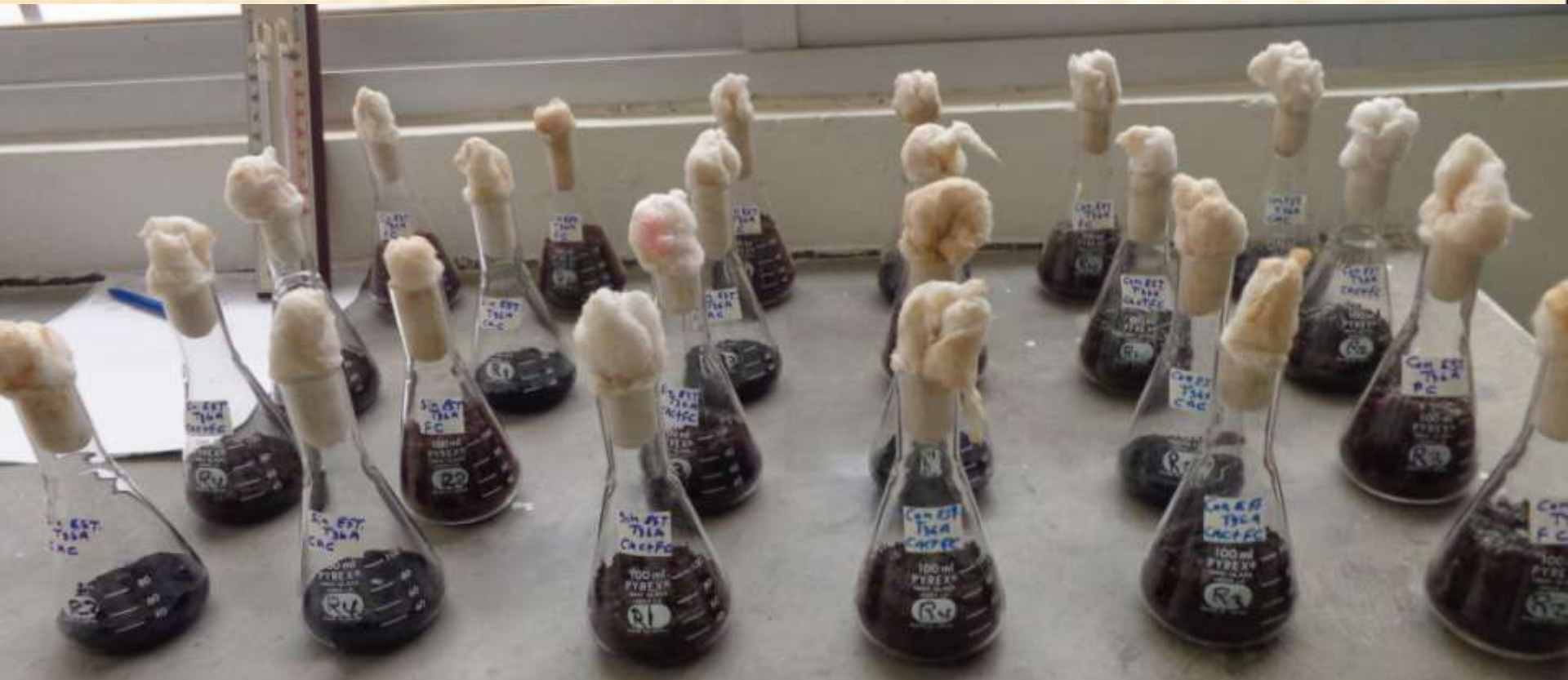
Fig. 6. Frasco Erlenmeyer con 15 gramos de sustrato más el inóculo
