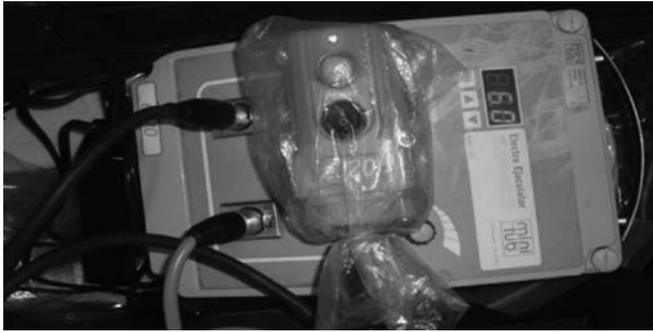
Figura 1. Equipo electroeyaculador (sondas y panel de control)
