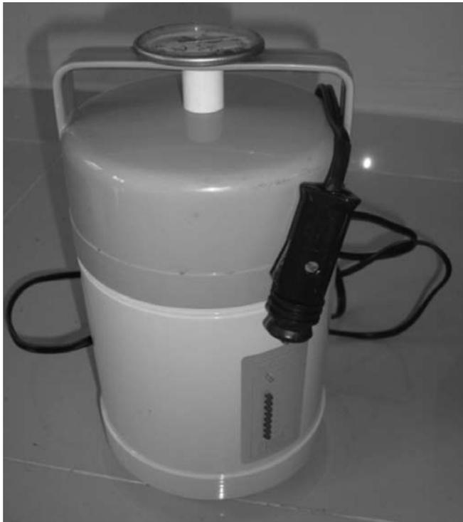
Figura 7. Introducción de la muestra en un termo con agua temperada (37 °C), debidamente tapado.
